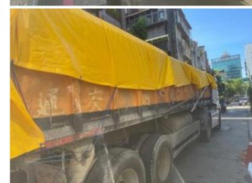
防塵布或不透氣覆蓋物緊密覆蓋及防止載運物料掉落地面之防制設施
